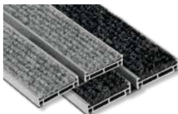
La gamme ROMAT est constituée de profilés en ALU BRUT dans lesquels viennent s'insérer des bandes de moquette (certaines avec classement feu) et caoutchouc anti-salissure spécialement étudiées. Les profilés sont reliés entre eux par des bandes d'assemblage en PVC souple placées sous les profilés, amortissant les bruits d'impact du trafic et permettant l'enroulage du tapis. Épaisseur des profilés : 1,5 mm.
