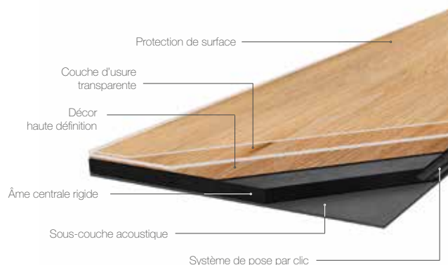
Exemple de construction de LVT à clipser (type Lifestyle Granit 55 Evo)
